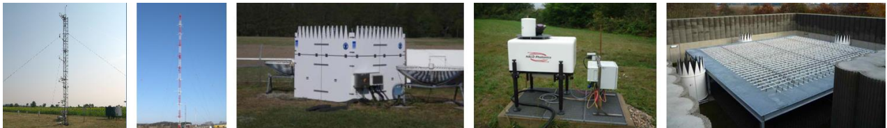
Abb.1: Windmesssysteme für das Komposit (von links nach rechts): Masten Falkenberg, Doppler-Sodar Falkenberg, Doppler-Lidar (Lindenberg und Falkenberg), Radar-Windprofiler Lindenberg
