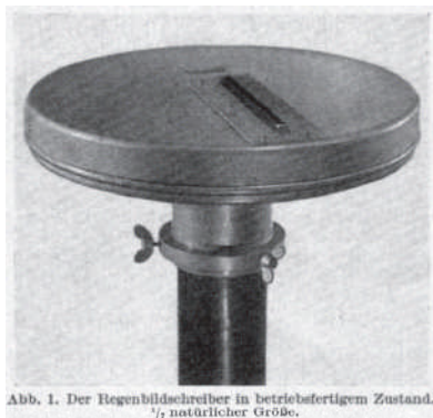
Abb. 2: Foto des Regenbildschreibers bei KOPP, 1954. Das Gerät hat im Original einen Durchmesser von ca. 70 cm, das Museum verfügt über den oberen Messkopf ohne Standrohr.
