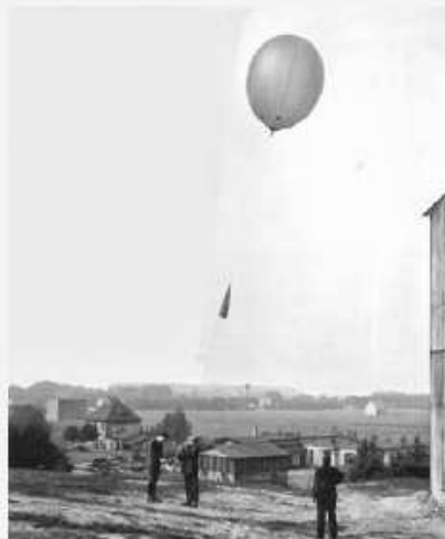
Aufstieg eines Gummiballons mit Fallschirm und Registrierinstrument um 1930 Quelle: Privatsammlung H. Steinhagen
