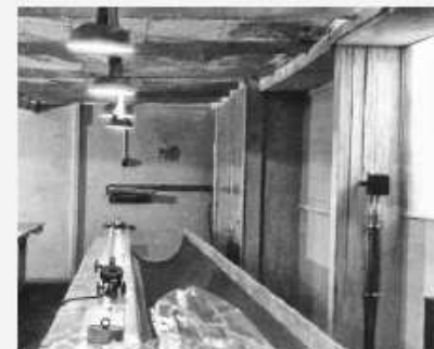
Ballonwerft in der Ballonhalle an der Herzberger Straße mit Wanne zur Aufnahme der Ballonfolie und kleinem Schweißroboter zur Ballonfertigung Quelle: Deutscher Wetterdienst, Archiv des Meteorologischen Observatoriums Lindenberg
